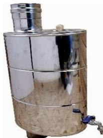
*Le chauffe-eau modèle tuyau en acier inoxydable est placé directement sur le dessus du poêle et le réservoir contient 24 litres d'eau. L'eau se réchauffe rapidement, car le tuyau de fumée traverse le réservoir et agit comme un mur à l'intérieur. Réservoir pour le chauffage de l'eau - d.115 (haut+/bas-).*
