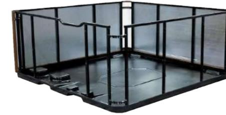
Tous les spas de nage **FLOW SPAS** sont équipés d'une **structure en acier galvanisé**. Avec son traitement anticorrosion, cette structure permet de supporter le poids du spa au cours des années et de résister aux environnements humides et à l'épreuve du temps. Tous les spas de nage de la gamme sont complétés par une **base en ABS** qui permet de les isoler, en plus d'offrir une excellente finition et d'éviter des déperditions de chaleur.
